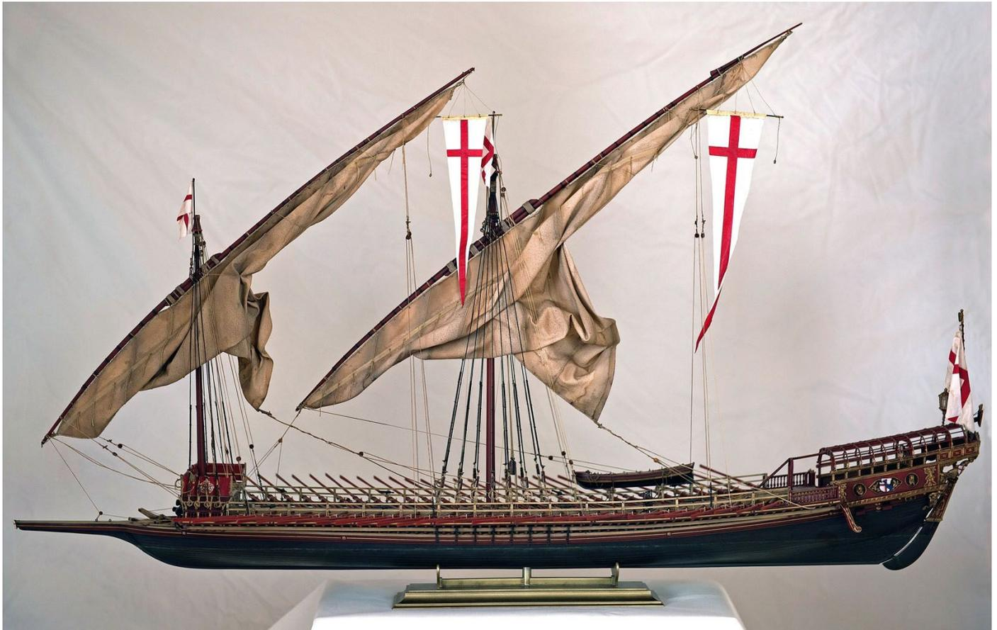
Con Galea, o Galera, si intende un bastimento lungo e sottile, a vela latina, a remo scaloccio (*NdR Un tipo di remo lungo e pesante che, manovrato da tre o più rematori posti sullo stesso banco, era in dotazione alla galea*), usato generalmente in guerra. Lo scafo è lungo e basso sull'acqua ed è fornito di uno sperone. A poppa è fornito di un piccolo castello con balaustra intorno. Le flotte di Arabi, Turchi, Spagnoli, Francesi, Genovesi (\*) e Veneziani erano formate in prevalenza da galere.
